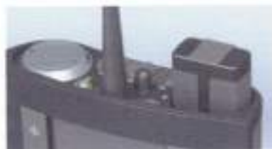
所有插头、传感器和端口均采用密封件保护, 防止防水防尘。
