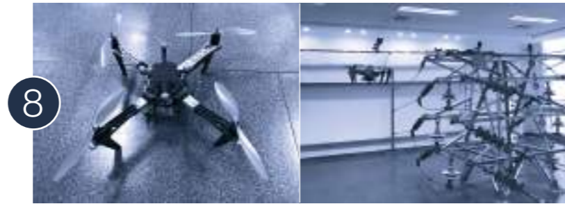
8 无人机实时定位,对电力塔架进行巡检 中国电力科学研究院
